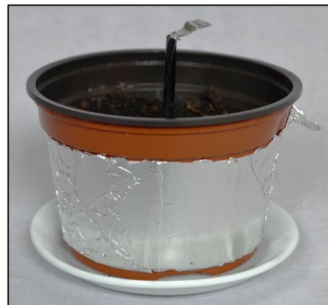
Abbildung 35: Blumentopf als Feuchtigkeitssensor
